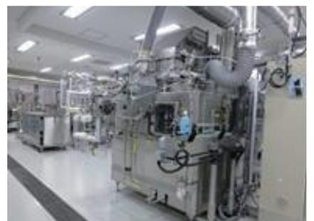
図15 飲料PETボトル用無菌充填システム
